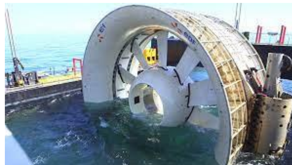
Hydrolienne en test Côtes d'Armor
